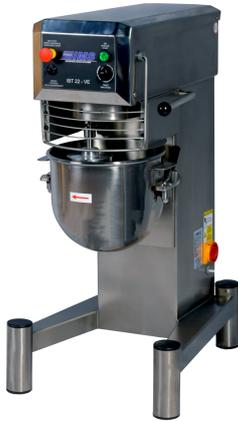
**IBT 22-33** Batidora planetaria de 20 L, tapa de seguridad de acero inoxidable, con motor de 3 velocidades (68-136-201 rpm). Sistema planetario sin aceite. Equipado con un gancho en espiral, paleta, batidor.
