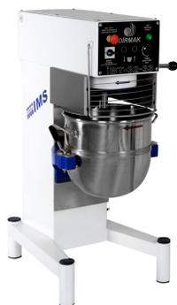
**IBT 32-33** Batidora planetaria de 30 l, tapa de seguridad de acero inoxidable, con motor de 3 velocidades (68-136-201 rpm). Sistema planetario sin aceite. Equipado con gancho en espiral, paleta, batidor.
